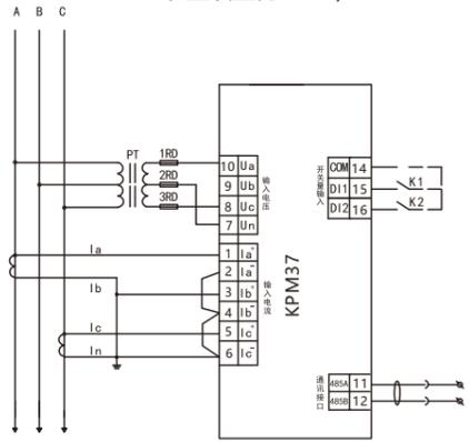
角型系统: 2个电压互感器 (PT)、2个电流互感器 (CT) (装置设置为P3L2)
