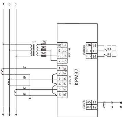
角型系统: 2个电压互感器 (PT)、3个电流互感器 (CT) (装置设置为P3L3)
